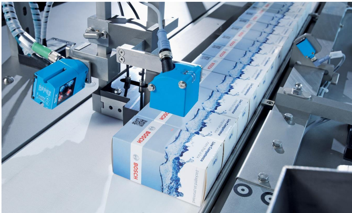
写真：『Glare』センサーが組み込まれた BOSCH の包装ソリューション
